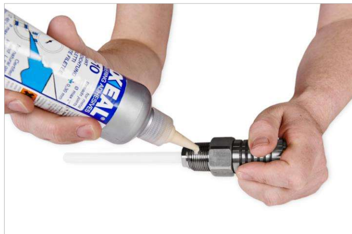
Aplique una junta líquida/Teflon a la rosca cónica.
