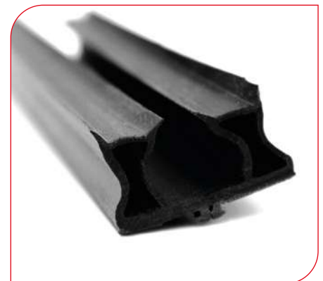
Bulete perimetral de EPDM flexible con fijación a la hoja mediante una flecha alojada en el perfil de alojamiento. De fácil sustitución.
