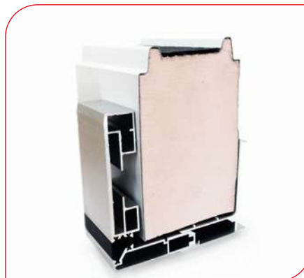
Marco telescópico con rotura de puente térmico frontal: sistema innovador de marco y contramarco telescópico ( \pm 40 mm) para adaptar perfectamente la fijación a pared de panel o muro obra, de (60-100 / 100-140 / 140-180 / 180-220)mm sin importar la medida de longitud.
