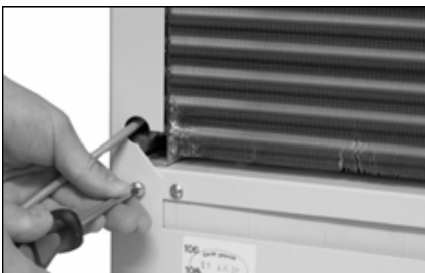
Imagen 27: Extraer los tornillos de fijación de la cubierta (extraer cuatro tornillos)
