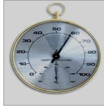
Termohigrómetro Ref.45.2028.00 Metal cromado Pelo sintético Zona de confort Rango: 0 a 100% -10 a 50°C Diámetro 120 mm
