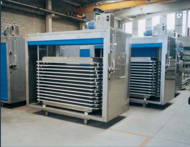
Armarios con cabina. Cierre mediante cortinas
