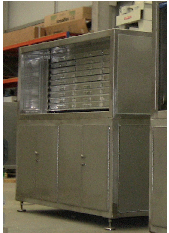
Armario de congelación IQF autónomo (el conjunto formado por el armario y el equipo frigorífico sale de fábrica perfectamente conectado eléctrica y frigoríficamente).
