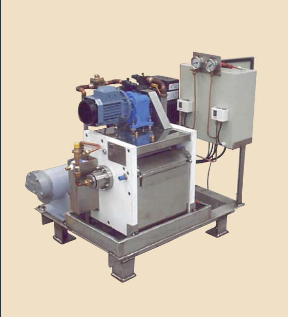
Generador de hielo en escamas compacto con capacidad para producir 1.000 Kg/24 horas. Condensación por agua de mar o agua dulce.
