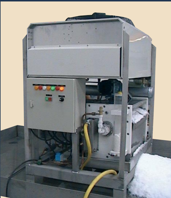
Generador de hielo en escamas compacto con capacidad para producir 2.500 Kg/24 horas. Condensación por aire.
