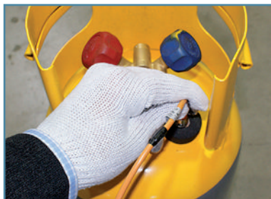
Figura 7: Conexión de OFP al enchufe del cilindro de recuperación
