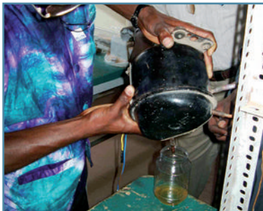
Figura 17: Extracción de una muestra de aceite de un compresor hermético
