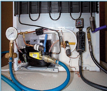
Figura 15: Ajuste para una prueba de capacidad
