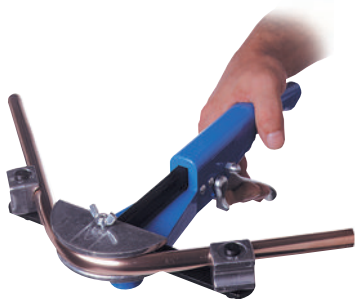
Ejemplo de herramienta y doblamiento de tubo de cobre
