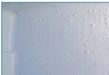
Figura 3a: Pared de un refrigerador (área del evaporador) con escarcha
