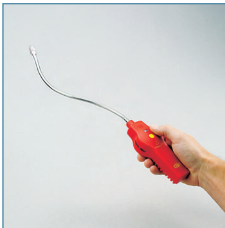
Figura 21: Prueba final de fugas con un detector electrónico de fugas 2
