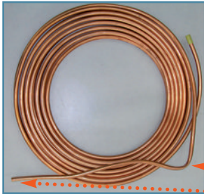
Figura 1: Tubo de cobre tratado en forma inapropiada
