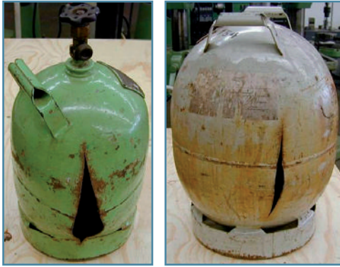
Figura 3: Ejemplos de cilindros que han estallado
