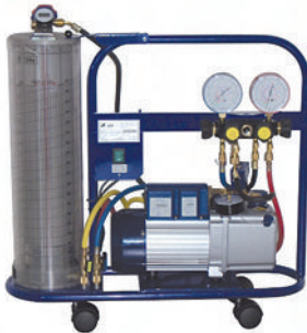
Figura 16: Estación de evacuación y carga
