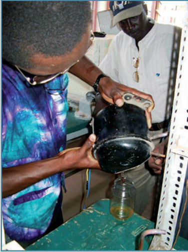
Figura 5: Drenaje de aceite de un compresor hermético
