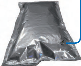
Figura 28: Conexión de la bolsa de recuperación con la salida de la bomba de vacío
