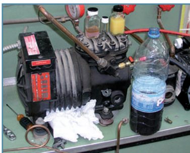
Figura 18: Extracción de una muestra de aceite de un compresor semihermético
