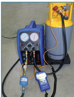
Figura 8: Arreglo de un cilindro de recuperación y una unidad de recuperación con conexión de OFP
