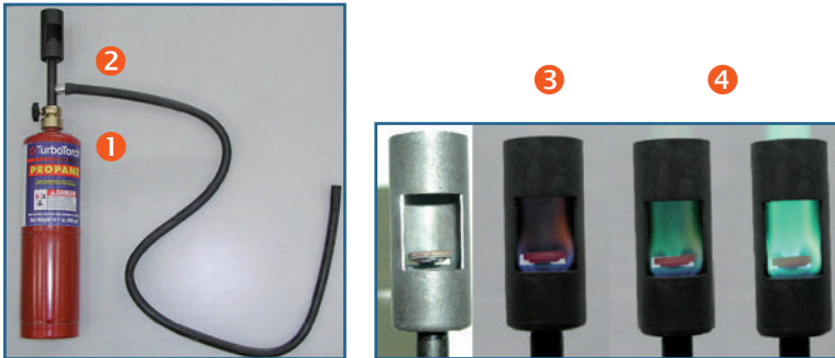
Figura 3: Detector de fugas mediante haluros (prohibido en la UE)
