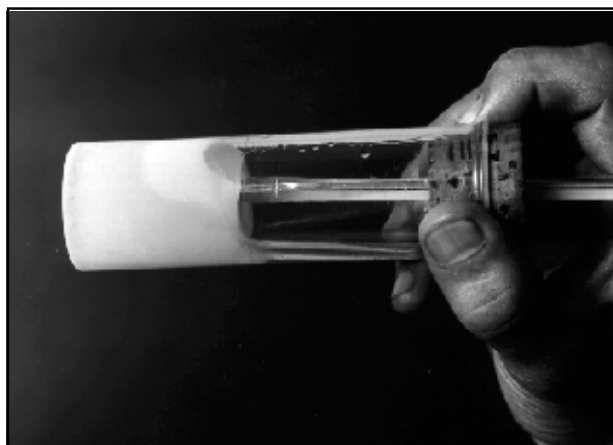
Figura 10.4 - Aparato utilizado para determinar el punto de esgurrimiento.
