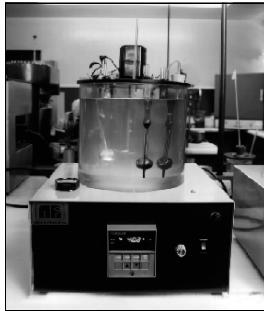
Figura 10.2 - Aparato utilizado para determinar la viscosidad cinemática.
