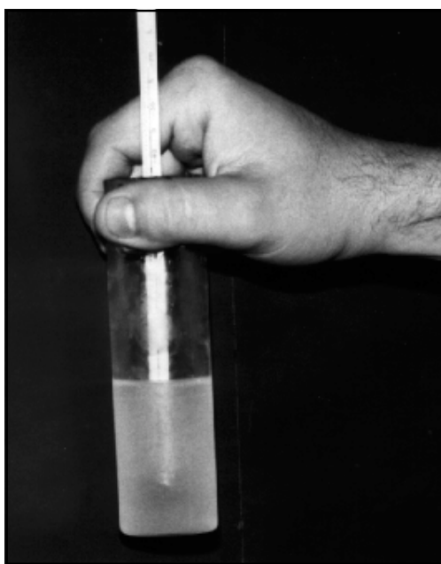
Figura 10.5 - Procedimiento para determinar el punto de floculación.
