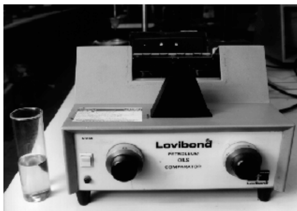
Figura 10.11 - Colorímetro utilizado para determinar el color ASTM.
