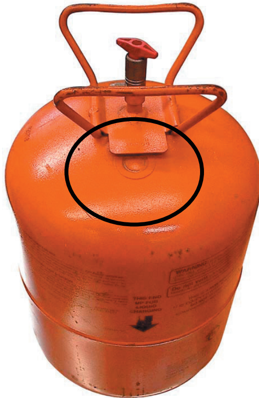
Ilustración 20. Cilindro señalando el disco de ruptura.
