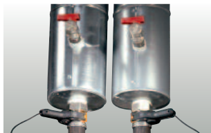
Sonda de pinza para tuberías de Ø 6 mm a Ø 35 mm, NTC
